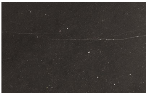
ESEMPIO DI LASTRA CON PRESENZA DI VENATURA
