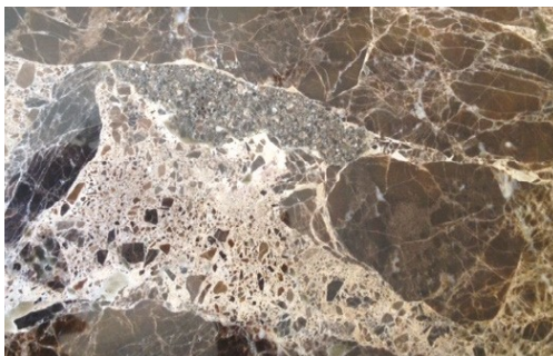
LASTRA CON STUCCATURA (DETTAGLIO)
